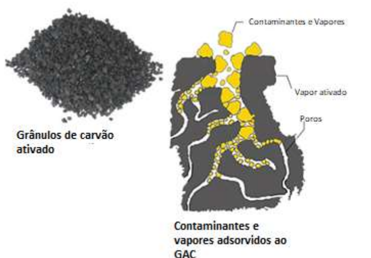
Figura 12: Desenho Esquemático – Contaminantes e vapores adsorvidos ao CAG
