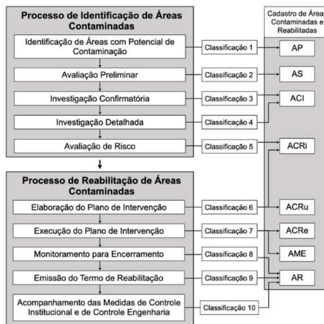
Figura 1: Fluxograma do Gerenciamento de águas Contaminadas
